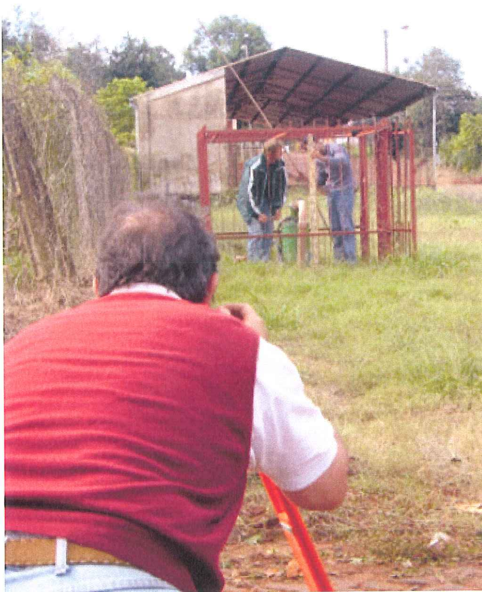
Nivelación entre Pozos N° 1 Y N° 5 – HOHENAU
